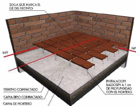
AXONOMETRICA COLOCACION BALDOSIN
